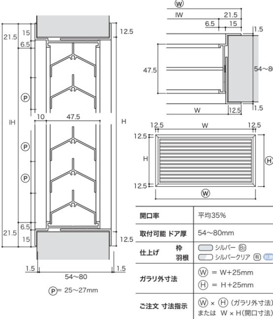
40mm厚用(高換気率タイプ) **YAG-4065V型** ●枠は溶接止めで堅牢に出来ています。
