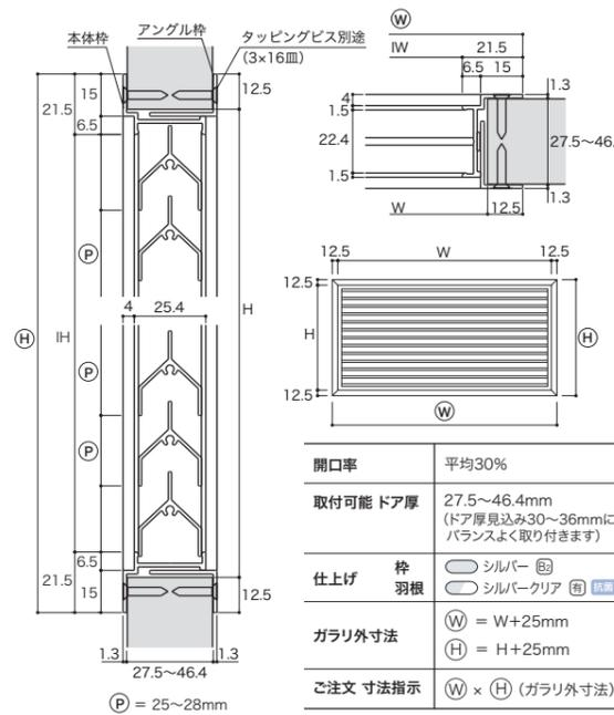
40mm厚用 **YAG-40Y型** ●枠は溶接止めで堅牢に出来ています。
