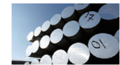
1 長尺ビレット (押出の材料)
