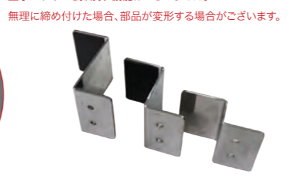
③ヒンジドアの隙間にプレートを挟みネジを回して固定 ※上下2か所に固定プレートがあります 設置金具は、商品を適正に固定させるものであり、 止水パッキンを押潰す機能はございません。 無理に締め付けた場合、部品が変形する場合がございます。
