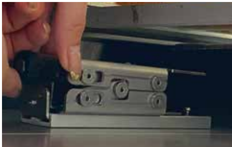
①ネジを回して設置金具のバネを緩める
