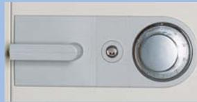
従来のダイヤル錠に比べ、解錠時にダイヤルを回す回数が半分になり、ダイヤル合わせの煩わしさを解消。更にダイヤル精度もアップ。安全性を高めました。ダイヤルが破壊されてもリッキング装置(破壊時再施錠装置)が働き、扉を開けることが出来ません。
