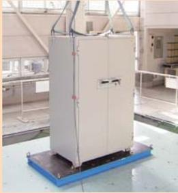
大震災(東北地方太平洋沖地震)の地震波を再現した耐震試験を実施し、耐震性能を確認しています。
