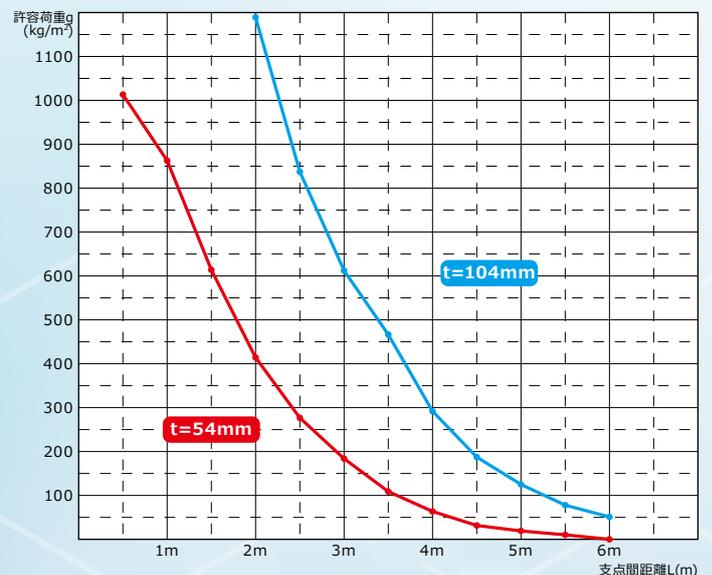
※使用するアルミ板材の厚み2.0mm・ハニカムコア厚み0.076mm・セルサイズ19.05mm。パネルの重量には枠材の重量も含まれますが、パネルの割り付け、枠材の形状により変動するため、平均値です。
